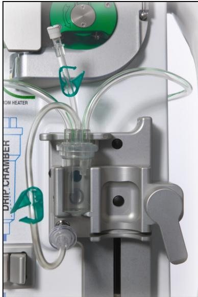
L'unité de dégazage automatique du système Aquarius fixe automatiquement le niveau dans la chambre de dégazage ( $\pm 1$  cm autour du faisceau lumineux). Le gaz à l'intérieur de la chambre de substitution, généré par le dégazage du liquide de substitution/dialysat, est éliminé au moyen d'une petite pompe située à l'intérieur du boîtier de l'UDA (placée à l'intérieur du système Aquarius).
