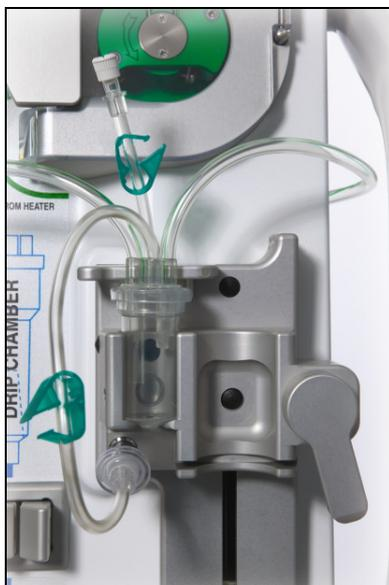
La unidad de desgasificación automática (ADU) del sistema Aquarius establece automáticamente el nivel en la cámara desgasificadora ( $\pm 1$  cm alrededor del haz de luz). El gas en el interior de la cámara de reposición, producido por la desgasificación del líquido de reposición/diálisis, es eliminado mediante una pequeña bomba dentro de la caja de la ADU (colocada dentro del sistema Aquarius).
